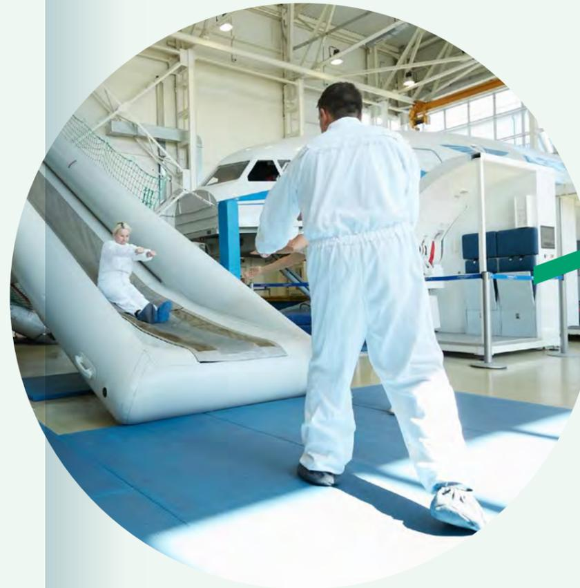
Тренажер эвакуации по аварийно-спасательным трапам для различных типов воздушных судов
